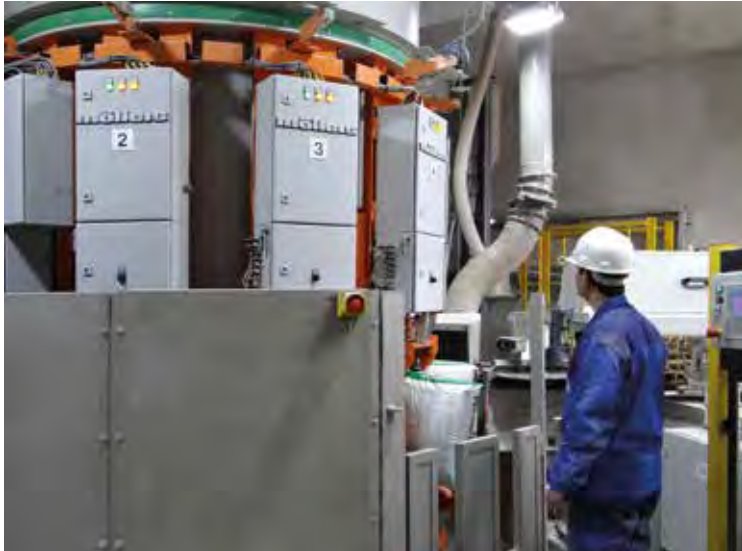
Mașina de înșăcuit tip Möllers pentru ciment zidărie Z 100 cu zece guri de alimentare
