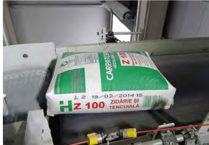
Banda alimentare instalație de paletizat
