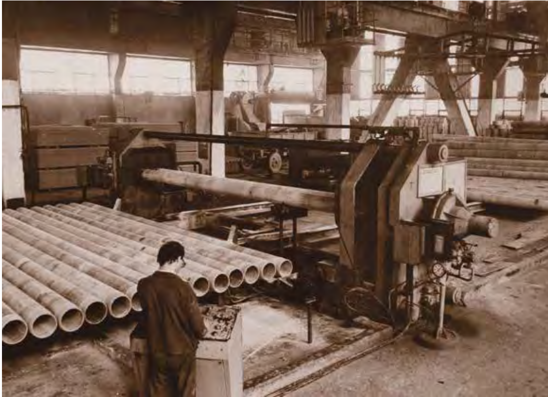
Verificarea rezistenței tuburilor de azbociment la presiune hidraulică
